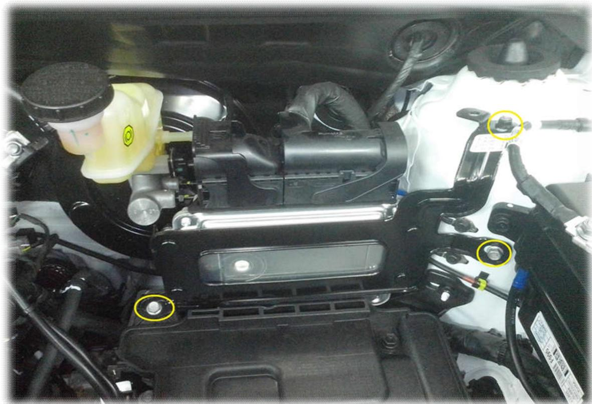
2. Приложить защиту, разметить два отверстия (См фото). Просверлить отверстия сверлом D-6мм.
